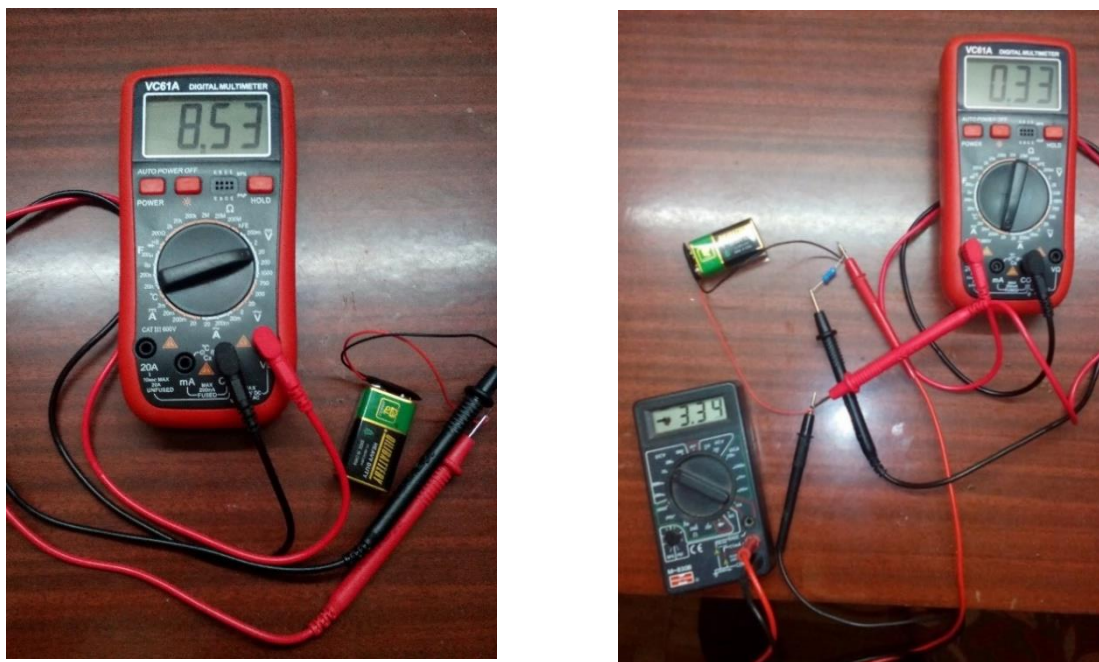
Рис. 11. Вимірювання внутрішнього опору батарейки – доповнення віртуального практикуму натурним
