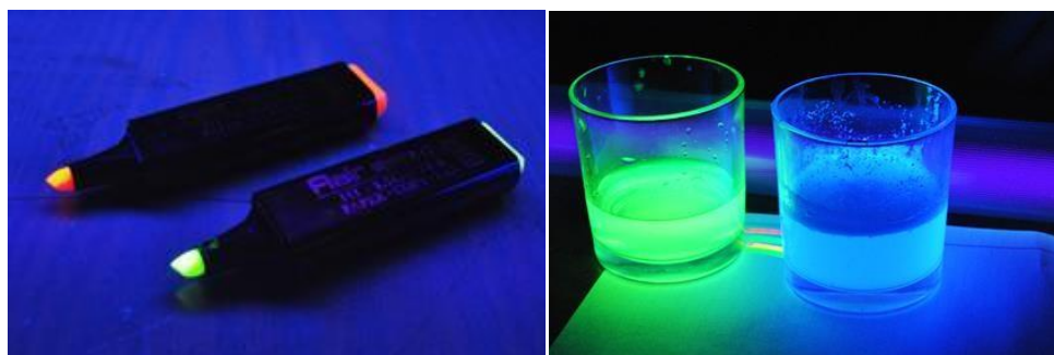
Рис. 8. Водні розчини чорнил з маркерів при УФ опромінюванні 23
