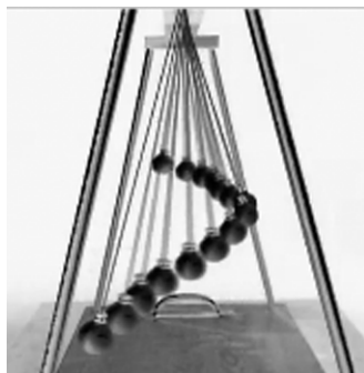
Рис. 3.6. Демонстрация бегущих волн при помощи математических маятников, закрепленных на нитях разной длины
