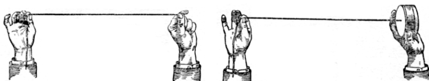
Рис. 4.13. Связь плохо излучающей струны (а) с хорошо излучающей мембраной (б)
