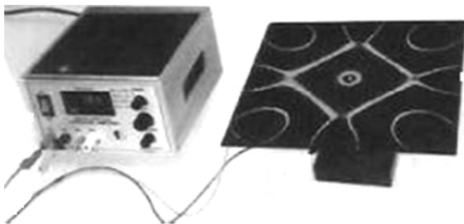
Рис. 6.18. Демонстрация фигур Хладни при помощи механического вибратора и звукового генератора. Современный лабораторный опыт
