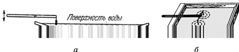
Рис. 5.2. Ванна для наблюдения поверхностных волновых полей (а), распространение волн от двух точечных источников (б)
