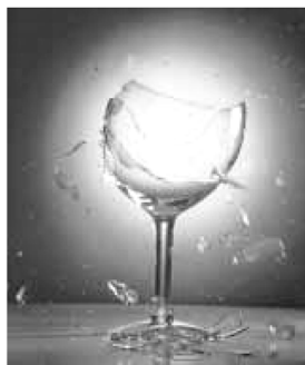
Рис. 4.10. Разрушение бокала в результате резонанса
