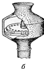
Рис. 4.3. Получение звука прерыванием струи воздуха (а), один из вариантов устройства сирены (б)
